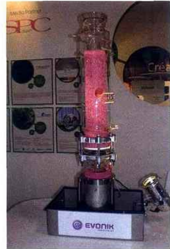
RÉACTEUR ENZYMATIQUE À COLONNE À BULLE D'EVONIK/ BUBBLE COLUMN ENZYME REACTOR OF EVONIK
